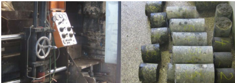
Figuur 11.6-1 – druksterkte kernen
