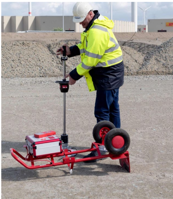
Figuur 11.4-1 – voorbeeld plaatproef
