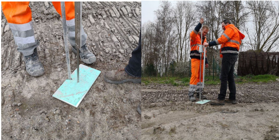
Figuur 11.5-1 – voorbeeld slagsondeproef
