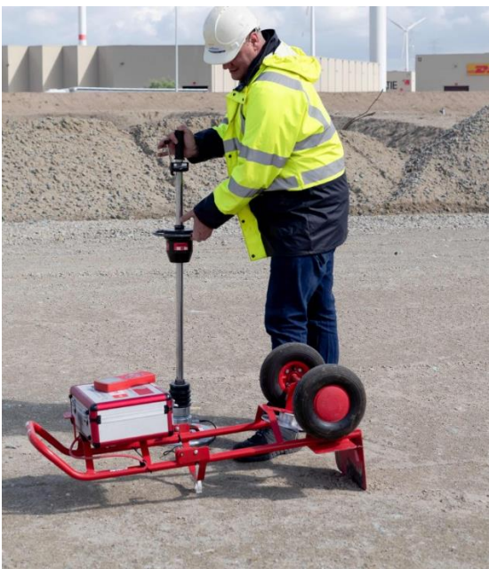
Figuur 11.4-1 – voorbeeld plaatproef
