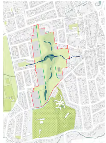
Systeem van grachten en wadi's voor opvang hemelwater
